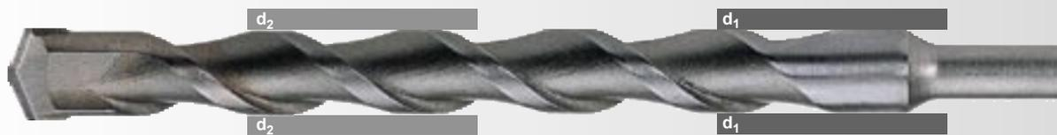
Износ спирали **S** определяется как разница между двумя диаметрами  $d_1$  и  $d_2$ .
