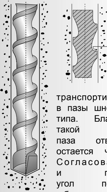
транспортируются в пазы шнекового типа. Благодаря такой форме пазы отверстие остается чистым. Согласованный и плоский угол подъема обеспечивает самостоятельный
