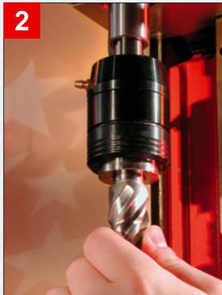
Рис. 2: Вставьте фрезу в EasyLock. Она зафиксируется громким щелчком. Стопорное кольцо защелкнется вниз.
