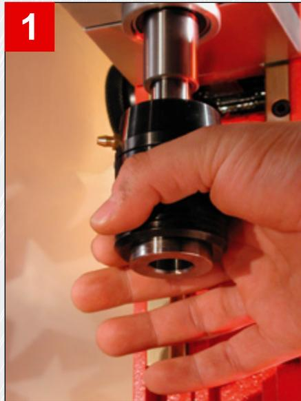
Рис. 1: Стопорное кольцо потяните вверх, пока оно не зафиксируется.
