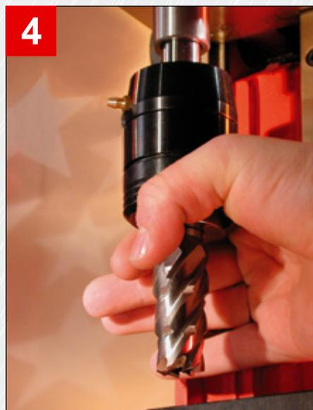
Рис. 4: Чтобы извлечь фрезу потяните стопорное кольцо вверх.
