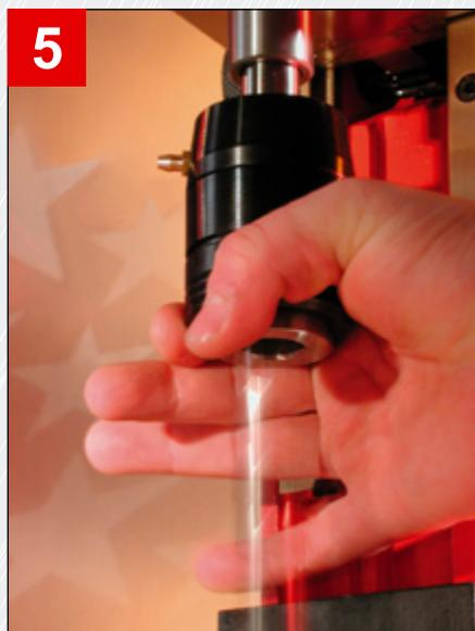
Рис. 5: Будьте внимательны! Фреза выпадет из EasyLock.
